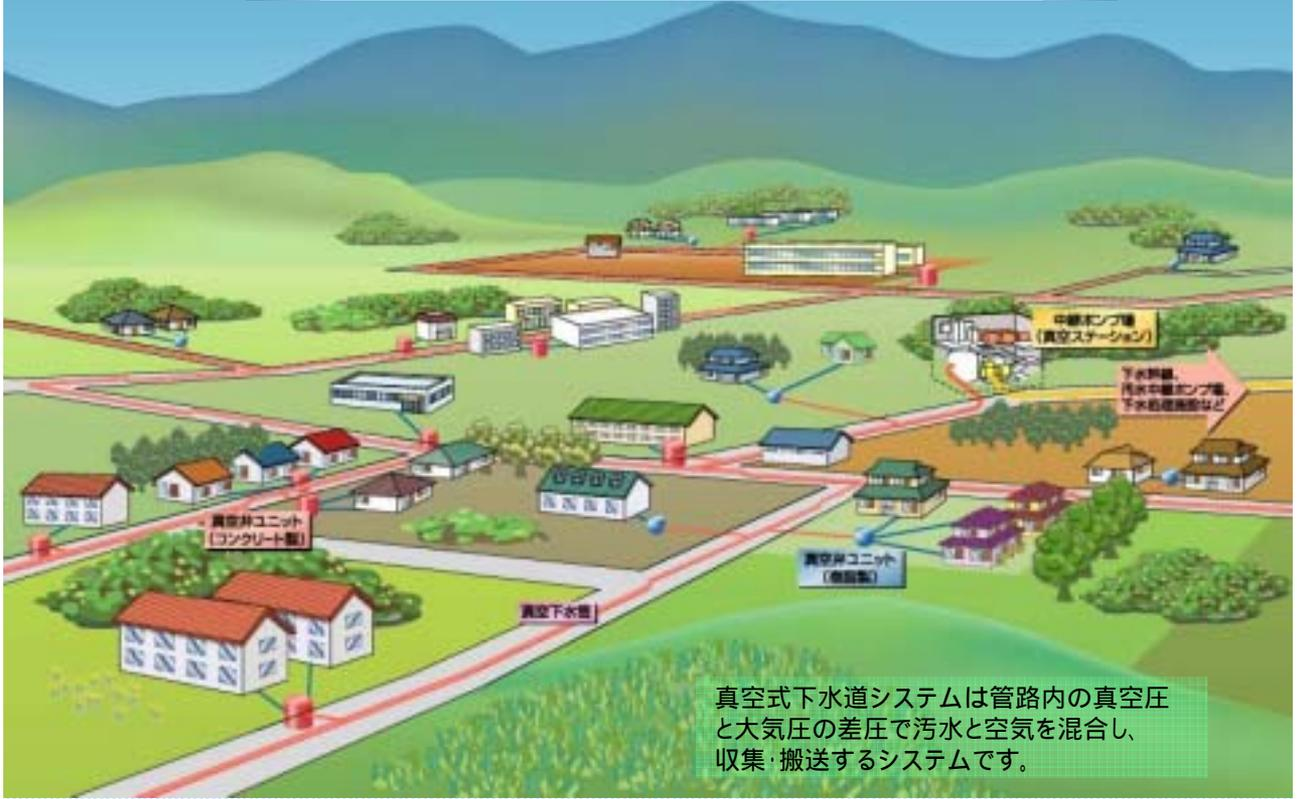
真空式下水道システムは管路内の真空圧と大気圧の差圧で汚水と空気を混合し、収集・搬送するシステムです。
