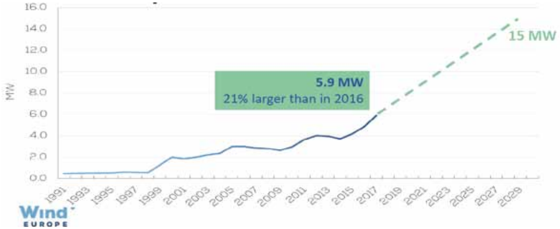
図1-3 新設された風車の1基当たりの設備容量の推移
