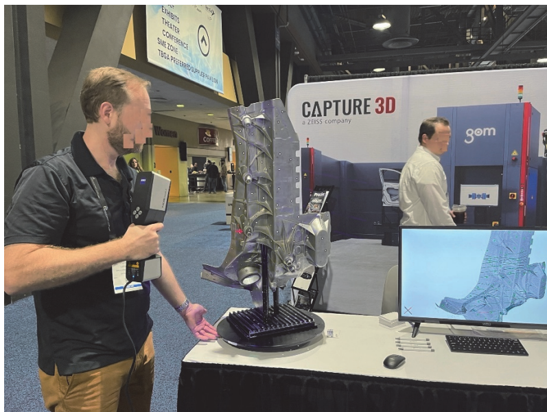
写真 4 : CAPTURE 3D 社のブースで実演されるポータブルのハンドヘルドレーザースキャナ
