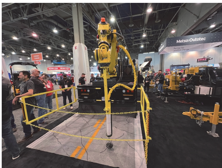
(写真9) 道路のダメージ調査と補修を行うロボット
