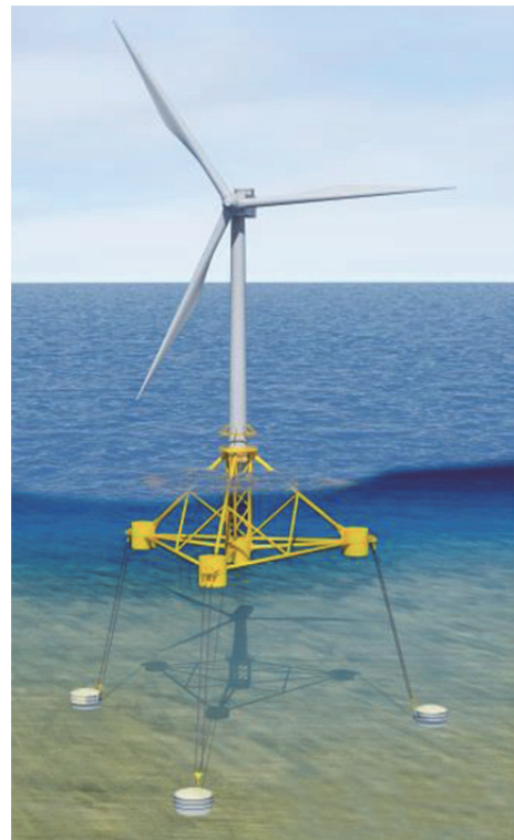
図5 TLP 式の例（SBM Offshore wind floater、SBM Offshore 社）
