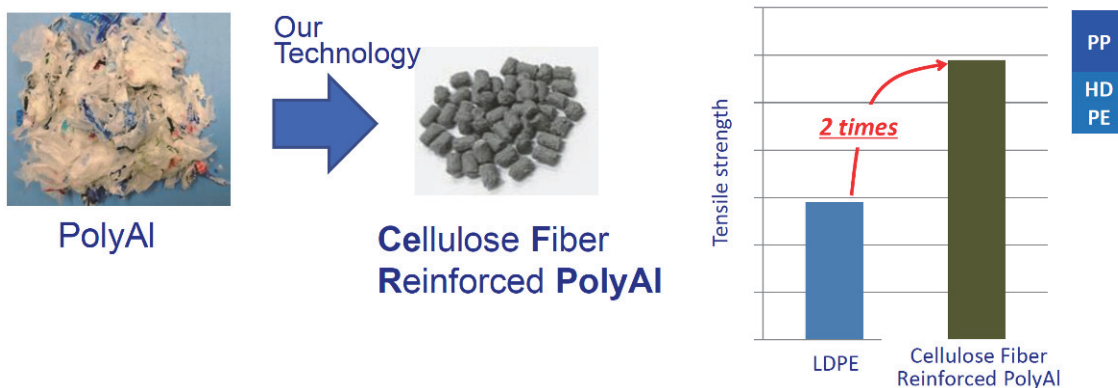
出典：Plastic Recycling Technology、Mikael Hamskog氏講演資料、Tetra Pak社 図2.4 セルロースファイバー強化プラスチックの強度
