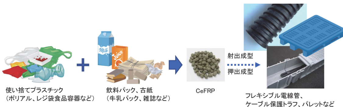
出典：Plastic Recycling Technology、Mikael Hamskog氏講演資料、Tetra Pak社 図2.6 CeFRPの材料と製品
