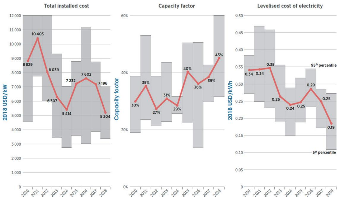
図10 CSPの設置コスト、設備利用率、LCOEの加重平均推移
