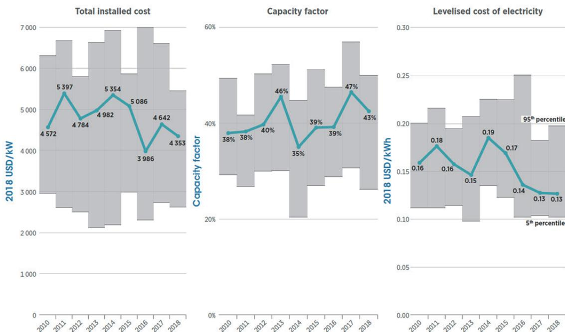
図8 洋上風力発電の設置コスト、設備利用率、LCOEの加重平均推移
