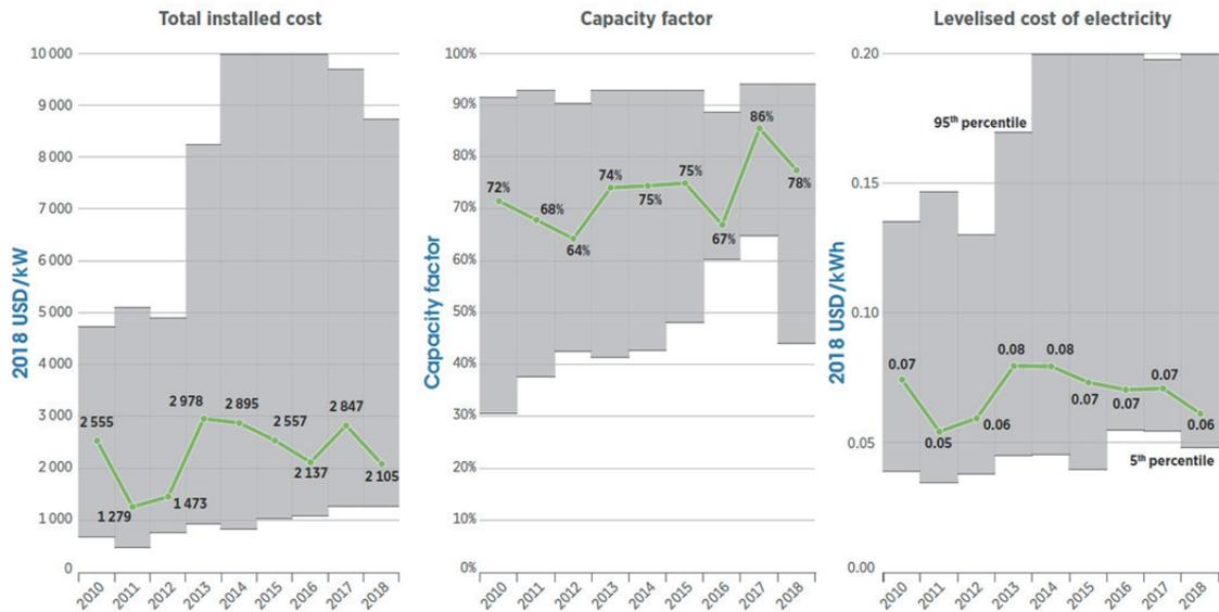
図14 バイオエネルギー発電の設置コスト、設備利用率、LCOEの加重平均推移
