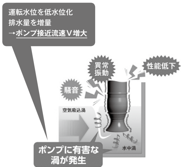
図1 有害な渦によるポンプへの悪影響
