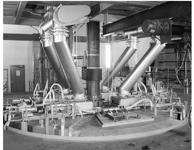
写真2 直立式電気抵抗炉外観
