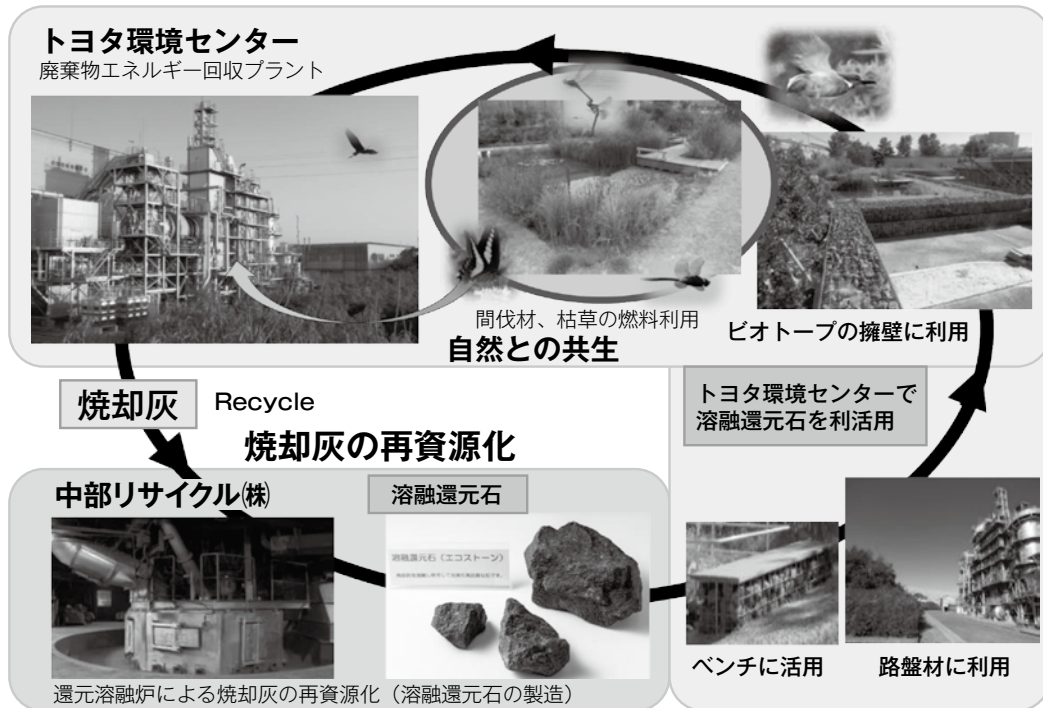
図2 完全リサイクル焼却プラントの基本的なコンセプト
