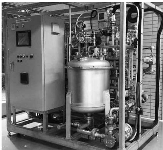
写真1 連続式加熱滅菌装置
