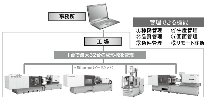
図8 T-Station lite Ver.2 システム構成図
