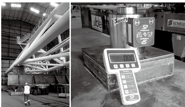
写真2 導入事例：フレアスタックの重量・重心測定
