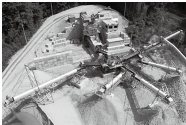
写真1 電動自走式プラント(生産能力300t/h)
