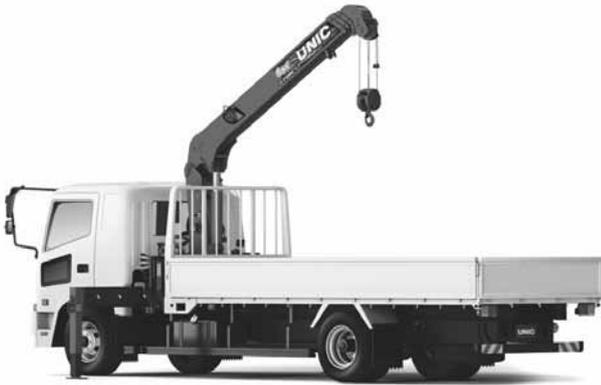
図1 中型トラック架装用クレーン(URG374UQKA)
