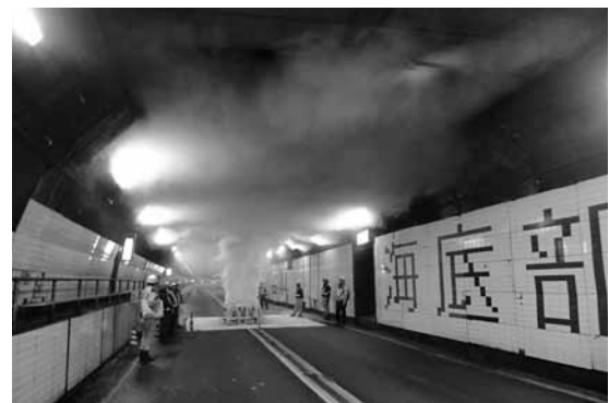
写真2 排煙試験状況
