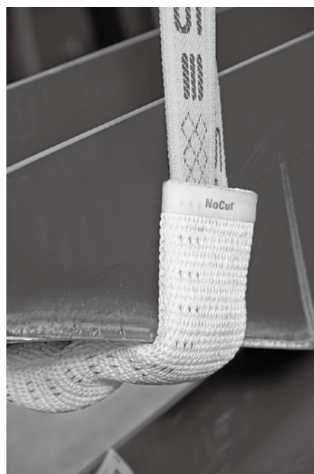
写真4 ポリエチレン製保護スリーブ使用例
