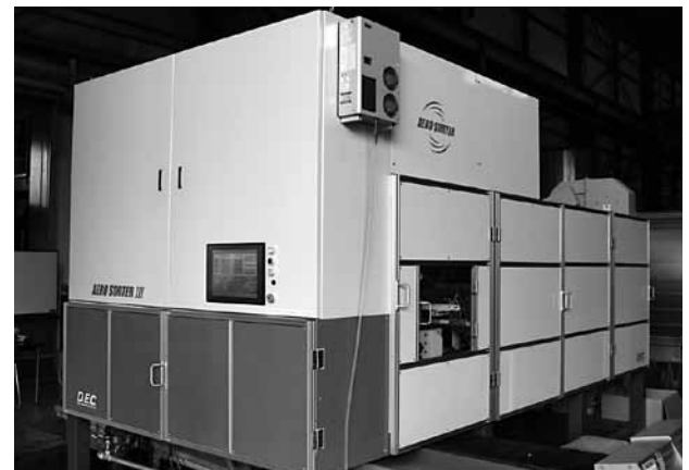
写真1 プラスチック材質選別装置の外観
