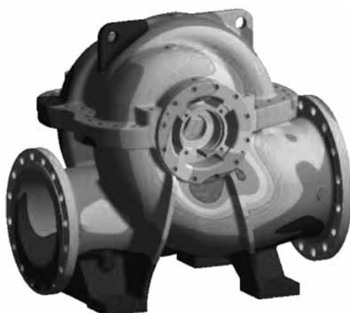
図2 ポンプ内部の圧力分布
