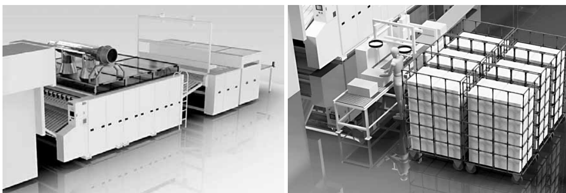
図3 シミ破れ検査装置(左)と金属検出機(右)
