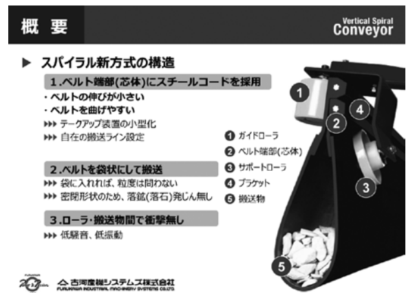
図4 スパイラル新方式の構造
