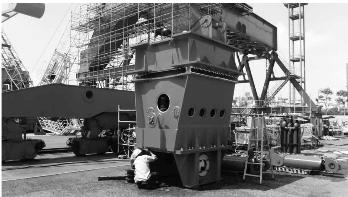
写真3 免震装置外観①（製作中）
