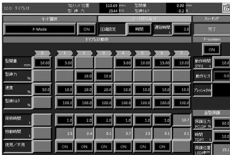
図6 DIPREST設定画面(型締圧縮⇄型開コアバックの多段設定画面)
