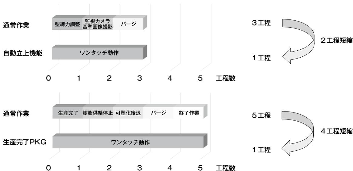
図4 自動立上機能・生産完了パッケージによる工程短縮
