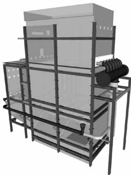
図3 船用SOxスクラバ外観
