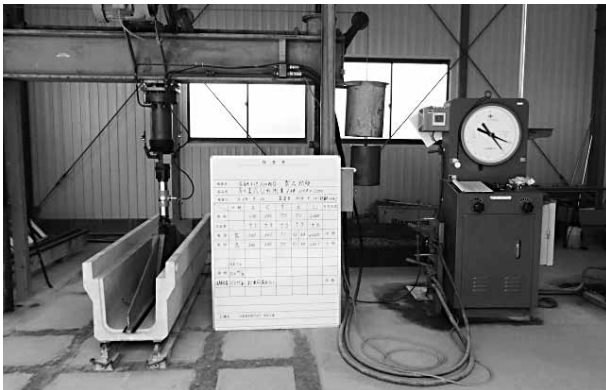
写真3 溶融スラグ入り落ち蓋式U形側溝製品寸法及び曲げ強度試験状況
