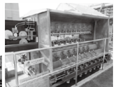
バタワース式レーヨン紡糸機
