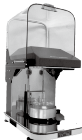
写真1 浸透試験装置ペネトアナライザPNT-N
