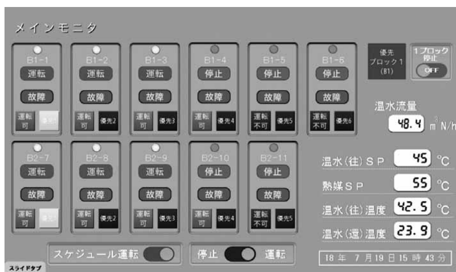
図4 UG温水トータルシステム画面例
