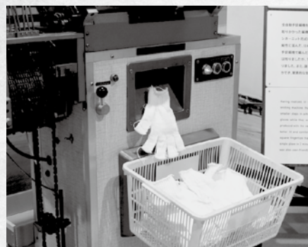
現存最古(1968年製)の全自動手袋編機が動態保存 概寸は、奥行き325×幅840×高さ1,200(mm)
