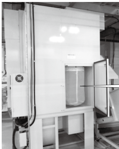
図2 ダストコレクタの構造
