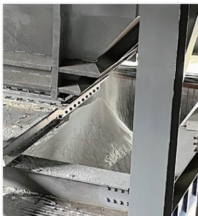
写真5 晶析装置の分離結晶
