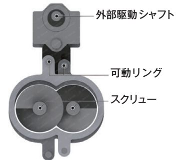
図2 シリンダーユニット断面図
