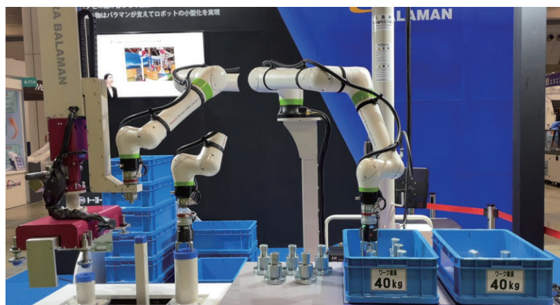
写真3 小物部品の箱詰め工程とハンド/アタッチメントの交換作業
