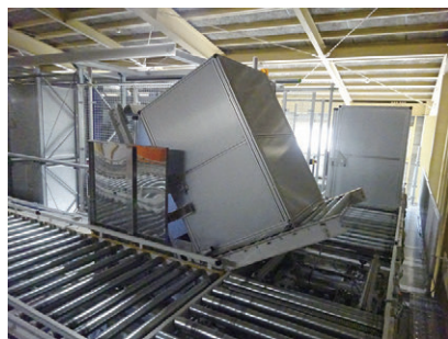
写真2 洗濯機投入位置にてコンテナが傾斜しリネンを洗濯機へ投入
