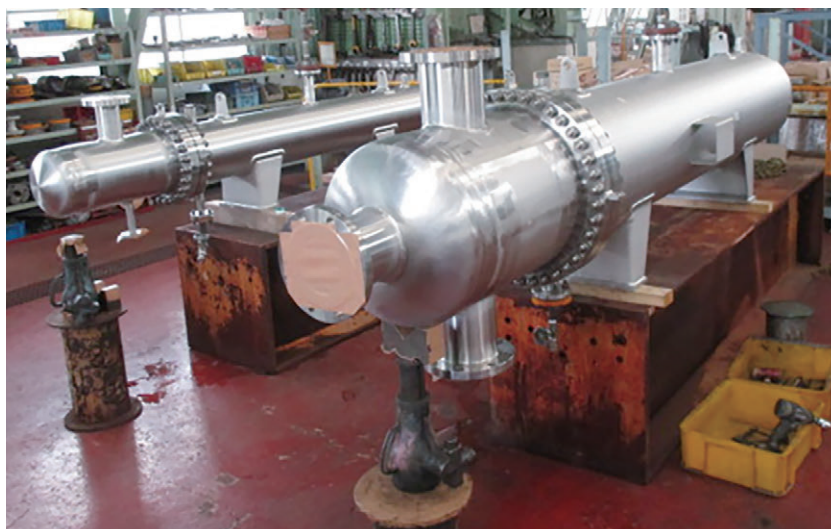
写真2 液化水素運搬船向けの当社製の液化水素気化器(左)及び水素ガス加熱器(右)
