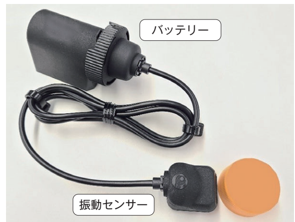
写真1 センサー、バッテリーユニット外観
