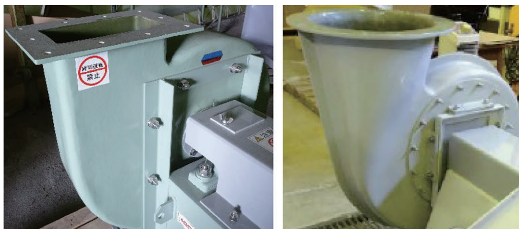
写真1 現行機(左)と開発機(右)のケーシング外観
