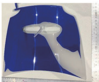
「サンドイッチ成形サンプル」 ●表層材：透明 PP ●コア材：着色(青)PP
