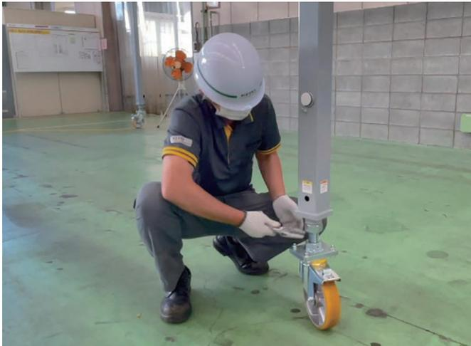
ジャッキボルトでクレーンの水平を調整
