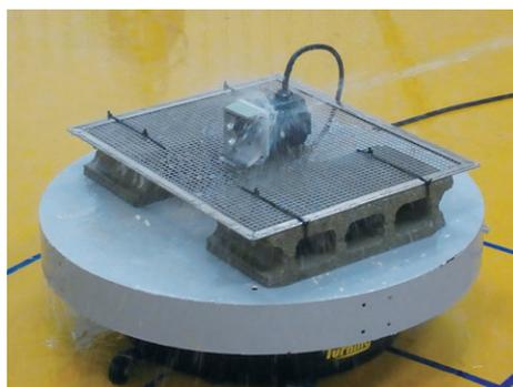
写真1 IP試験(上部：IP6□、下部IP□5)の様子
