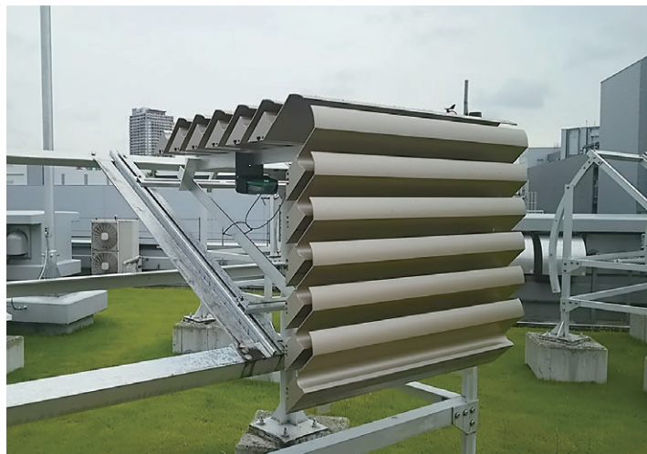
写真6 耐候試験 試験体設置状況
