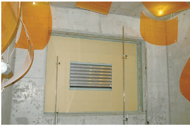
写真3 音響透過損失試験状況
