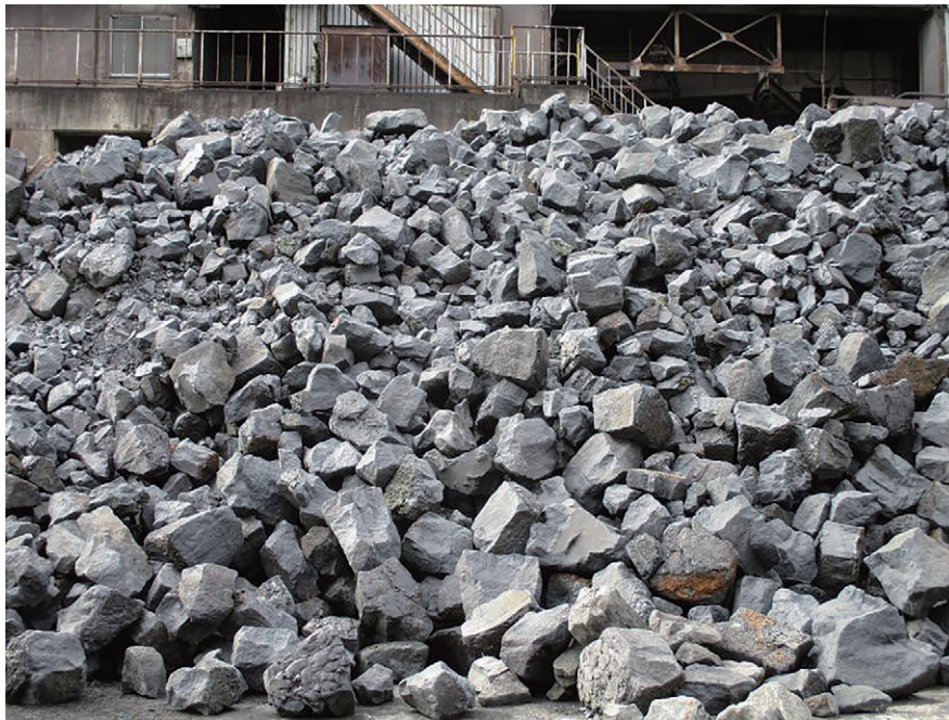
写真1 溶融還元石(裏込石) (1~70kg/個) 保管状況
