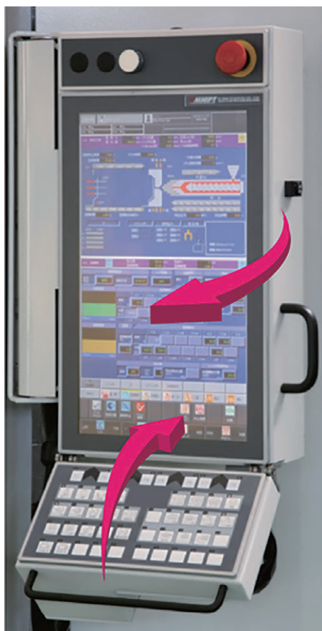
写真3 18.5インチモニター搭載の制御装置MAC-IX外観
