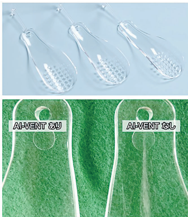
写真1 AI-VENT 乾燥レス成形品 / AI-VENTなし未乾燥成形品(シルバーストリーク)
