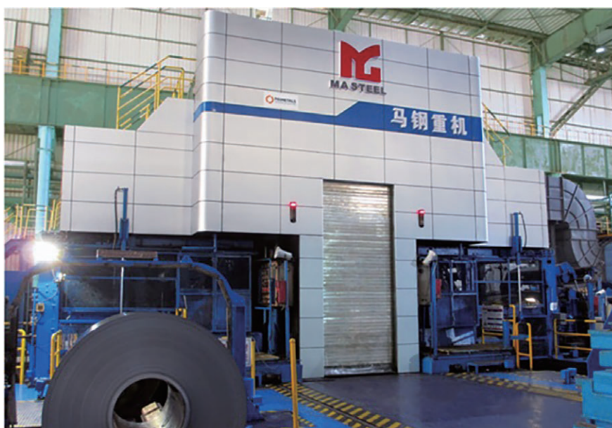
写真1 中国/馬鞍山鋼鐵廠 No.1 RCM (UCMをHYPER UCMへ改造)
