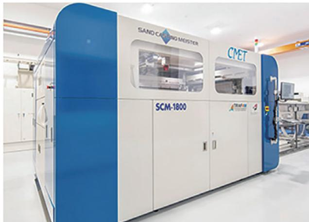
写真2 砂型3Dプリンタ：CMET社製 国産大型機
