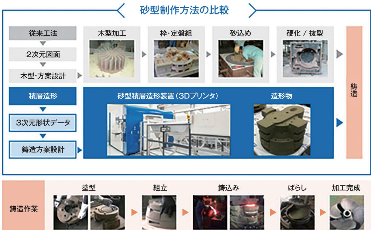
図1 砂型製作方法の比較
