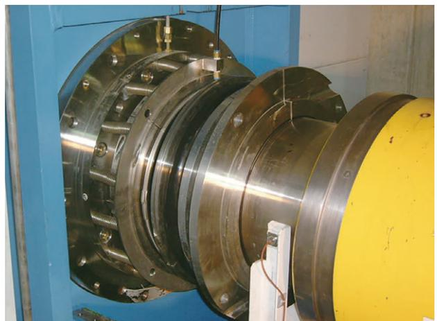
写真1 大変位吸収・大径ダイヤフラム形二分割シール実機装着状況
