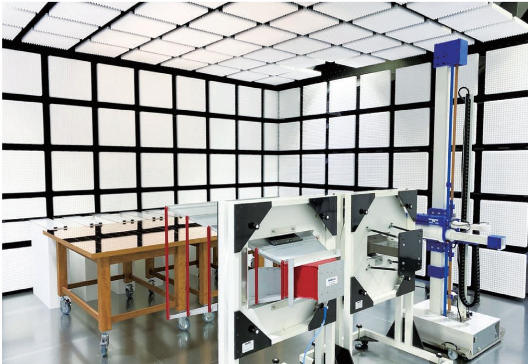
写真4 車載機器専用EMC暗室
