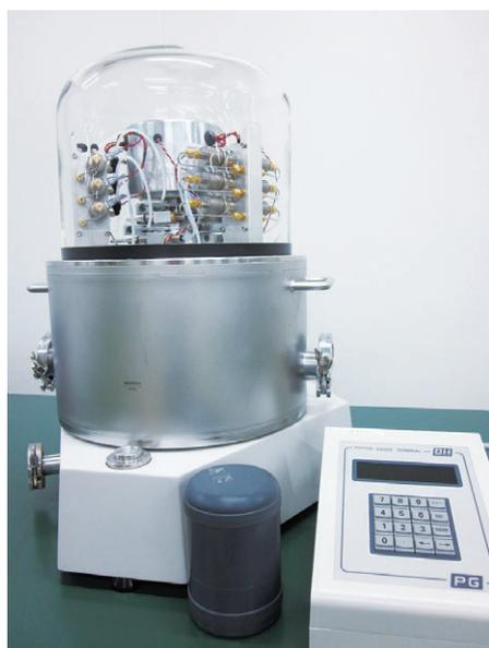
写真2 全自動気体重錘形圧力天びん
