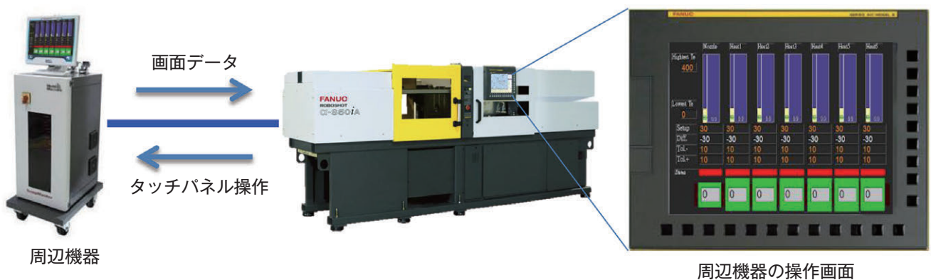
図3 VNC機能による周辺機器の遠隔操作
