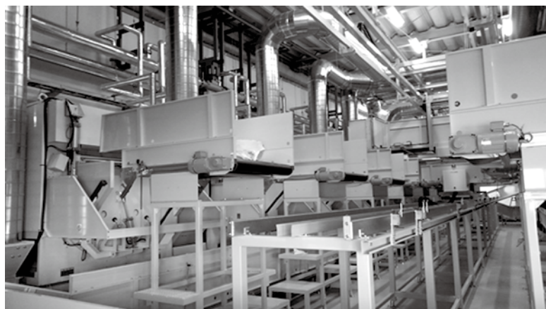
写真4 省スペース型乾燥機の設置例
