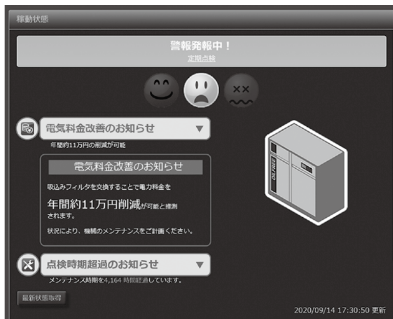
図1 FitLive ® 画面(上:吸込みフィルタ目詰まり判定機能、下:電力料金改善のお知らせ)
