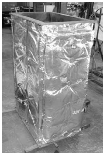
写真5 排熱回収器外観
