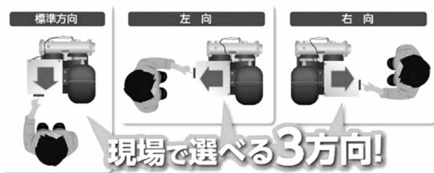
図3 制御盤の向き変更例
