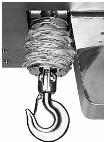
図7 ステンレス製フックとチェーンジャバラ
