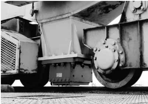
図2 ポジティブ式レールブレーキ
