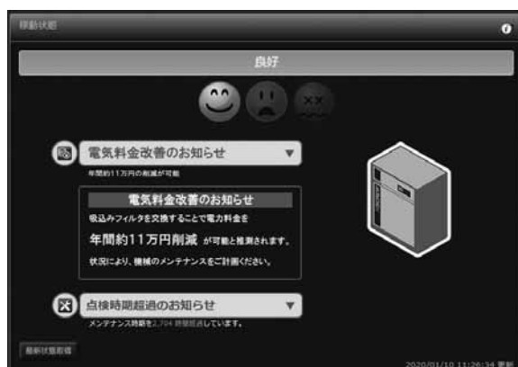
図1 FitLive画面(上:吸込みフィルタ目詰まり判定機能、下:電力料金改善のお知らせ)
