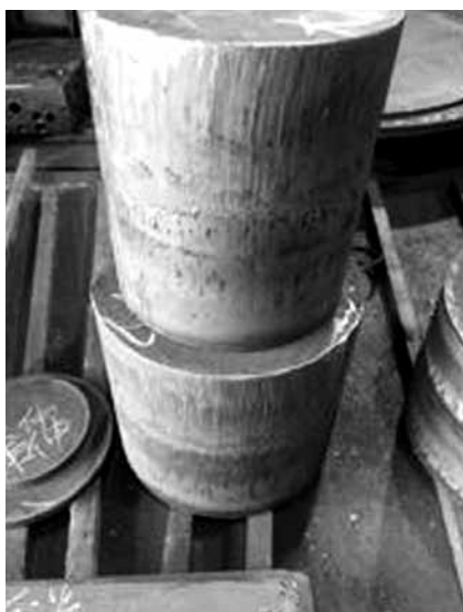
写真1 S53Cの350mmの精密溶断
