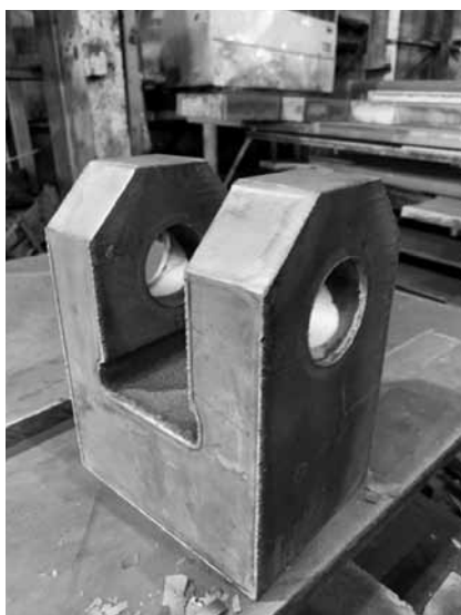
写真2 2方向からの精密溶断
