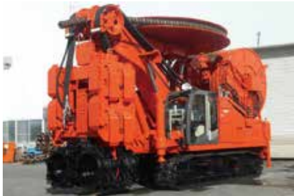
写真1 水平多軸式地中連壁機
