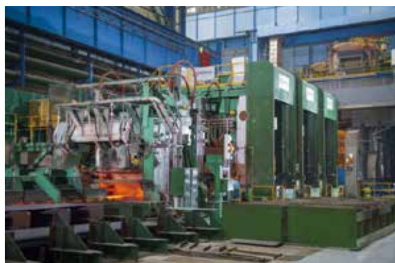
写真1 エンドレス圧延設備 (提供: Primetals Technologies Japan 株式会社)
