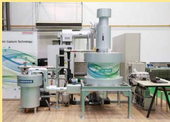
地球温暖化の原因物質のひとつとされるCO2を、特殊な吸収材により空気中から直接回収する技術です。設置場所を選ばずどこでも設置できるため、カーボンニュートラル実現の切り札と言われています。
