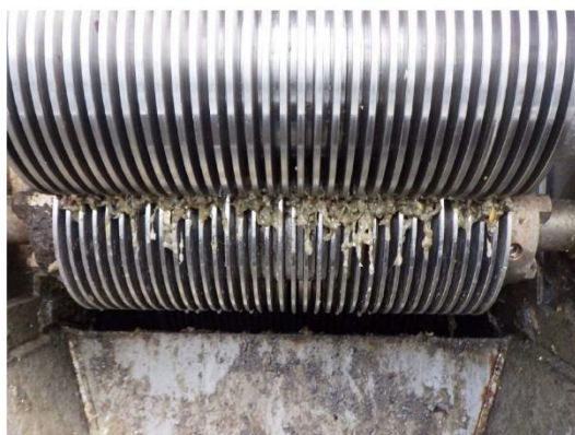
図表9 従来型（左）、本装置（右）のスクレーパ部し渣堆積状況の比較
