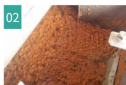
凝集混和タンク
