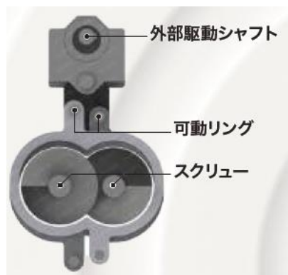
図表 1 シリンダーユニット断面図
