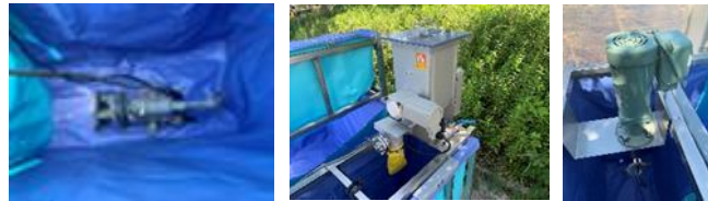
1) 反応槽内部・粉体フィーダー・攪拌機
