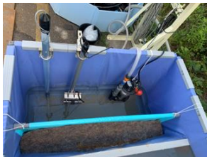
4) 処理水槽内部・①濁度計/②pH計（オプション）
