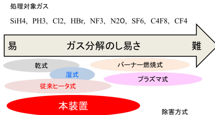
図表 4 処理対象ガスとそれに対応する排ガス処理装置
