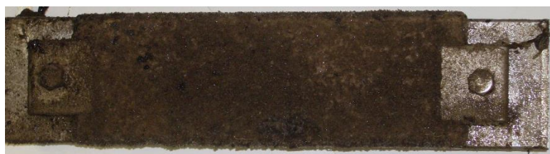
図表 8 MAP スケールによる散気装置目詰まり状況
