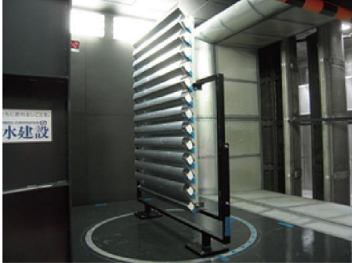
図表 15 風切り音実験の状況
