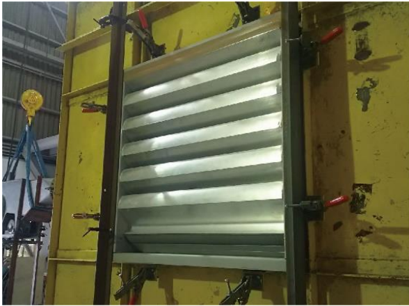
図表 12 通気性能試験の状況
