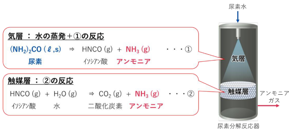
図表 3 尿素分解装置における尿素からアンモニアへの加水分解反応
