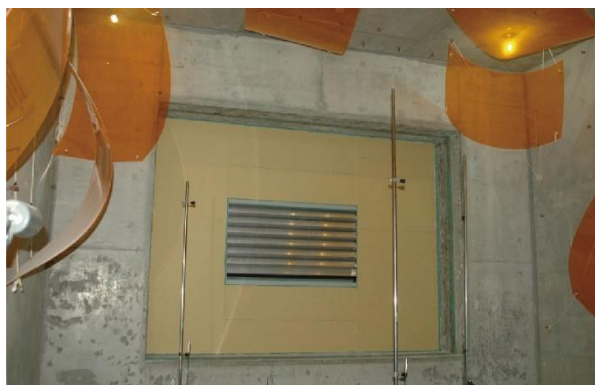
図表10 音響透過損失試験の状況
