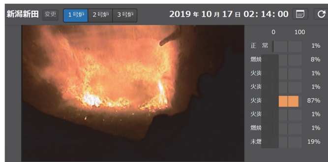
図5 燃焼画像システムによる数値化例（燃焼状態が不安定な場合）
