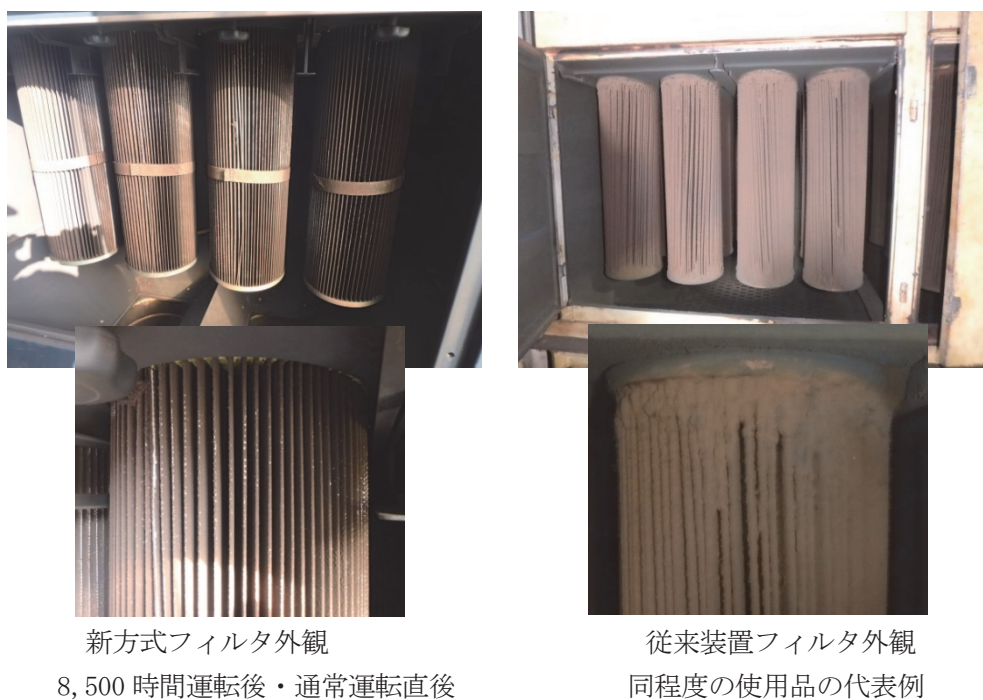
図9 従来方式と新方式とのフィルタ状態の比較例
