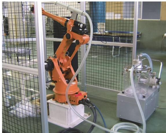
図7 ロボットアームに装備したプッシュプル式回収装置
