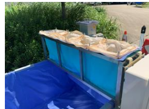
5) 汚泥脱水槽内部
