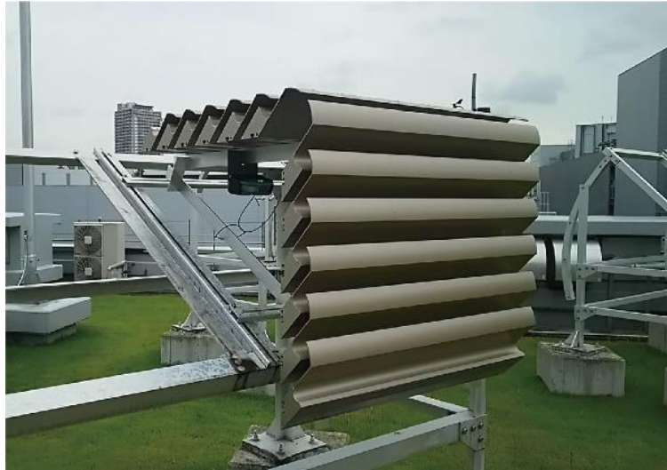
図表 17 耐候試験 試験体設置状況
